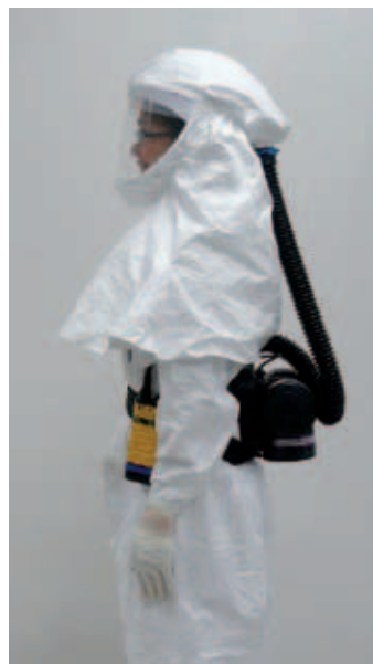
รูปที่ 5.5 อุปกรณ์ป้องกันระบบทางเดินหายใจแบบหน้ากากส่งผ่านอากาศระบบความดันบวก
